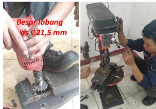
Gambar 13. Pengeboran roda gigi *sprocket*
