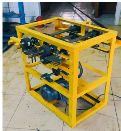
Gambar 23. Hasil akhir pembuatan mesin serut bambu
