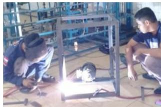
Gambar 3. Penyambungan rangka
