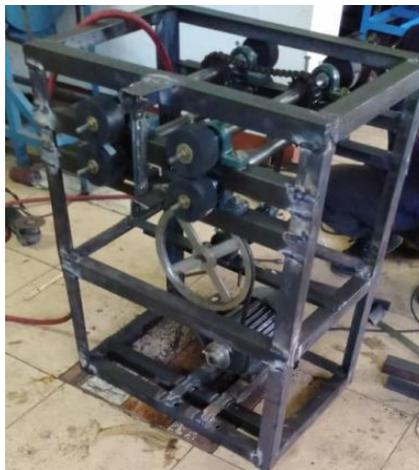
Gambar 20. Mesin serut bambu telah dirakit
