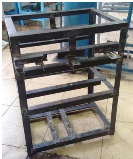
Gambar 4. Kontruksi Rangka Mesin Serut Bambu
