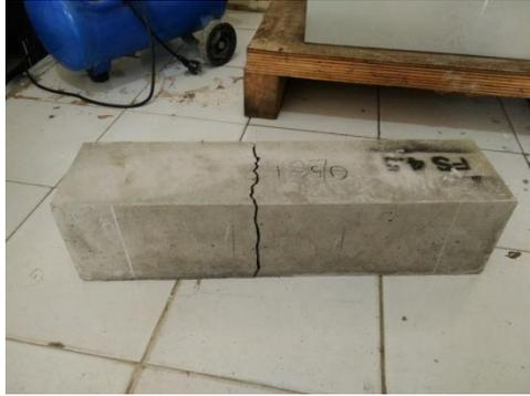
Gambar 2 Patahan Pada 1/3 Bentang Tengah
