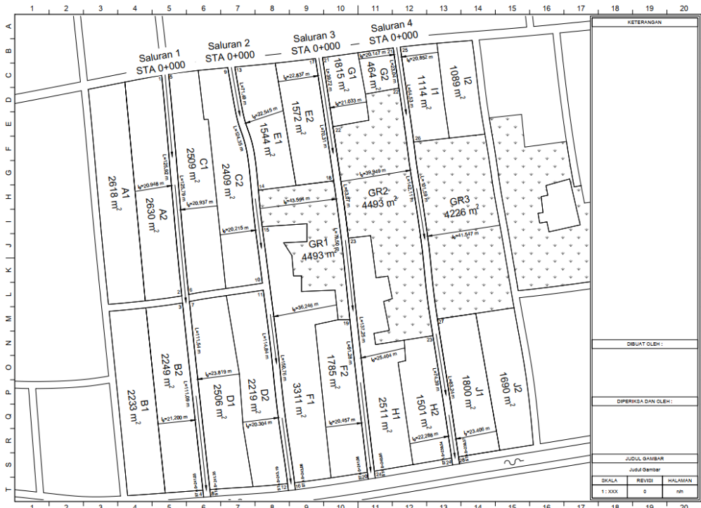
Gambar 1. Peta Situasi Rencana Saluran Drainase Tabel 3. Data-data untuk menentukan Waktu Konsentrasi (Tc)
